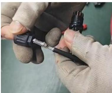
5) 将铜鼻子插入塑料本体，听到咔的一声铜鼻子安装到位；
