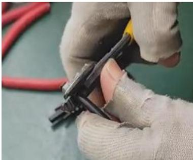
3) 将线放入铜鼻子，使用 MC4 压线钳压接。注意：标有“+”的塑料本体要使用孔型铜鼻子，标有“-”的塑料本体要使用针型铜鼻子；
